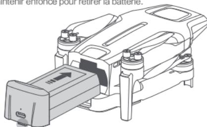
Clé de déverrouillage de la batterie
