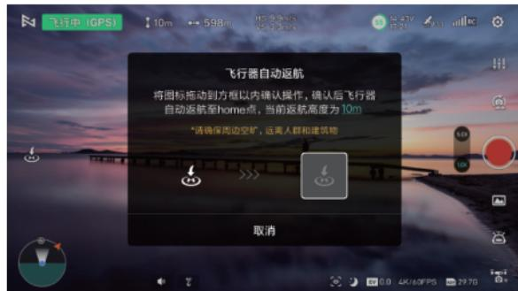
当飞行器在空中飞行时，用户可以长按遥控器上的返航按键让飞行器进入自动返航。当飞行器返航距离 $D < 10$ 米时，若飞行高度 $H < 3$ 米，则飞行器上升到3米后返回起飞点降落；若飞行高度 $H \geq 3$ 米，则飞行器直接保持当前高度返回起飞点降落。当飞行器返航距离 $D \geq 10$ 米时，若飞行高度 $H < 30$ 米，则飞行器先上升到30米后返回起飞点降落；若飞行高度 $H \geq 30$ 米，则飞行器直接保持当前高度返回起飞点降落。用户可以通过遥控器返航按键或者通过APP取消自动返航。
